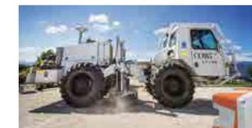
Camion vibreur et capteur «géophone» utilisés lors de la phase de prospection.
